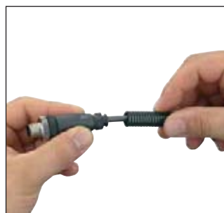
3. Colocar un tubo de protección PG7
