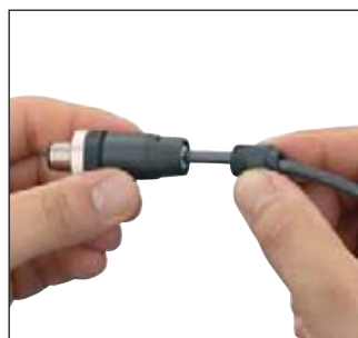
2. Atornillar el adaptador para el tubo de protección
